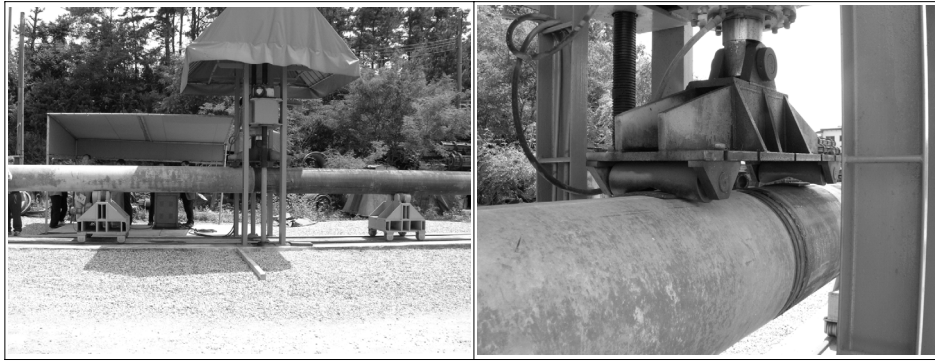
그림 8. HCP말뚝 bending 시험 전경
